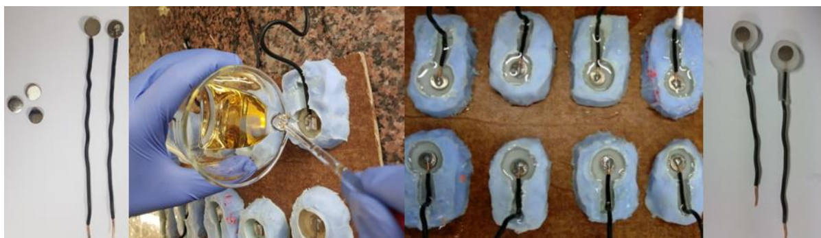
Slika 3.2. Postupak izrade radnih elektroda. 69
