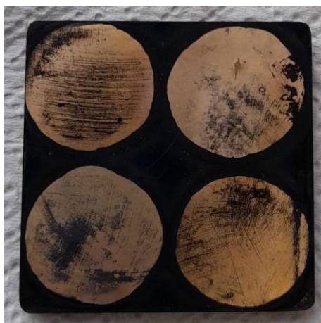
Slika 4.60. Ispitivanje prionjivosti premaza na patiniranoj površini bronce.
