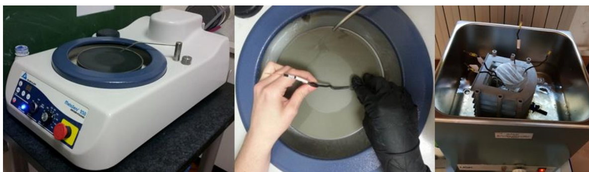
Slika 3.3. Mehaničko strojno poliranje uzoraka i odmašćivanje u ultrazvučnoj kupelji. 69
