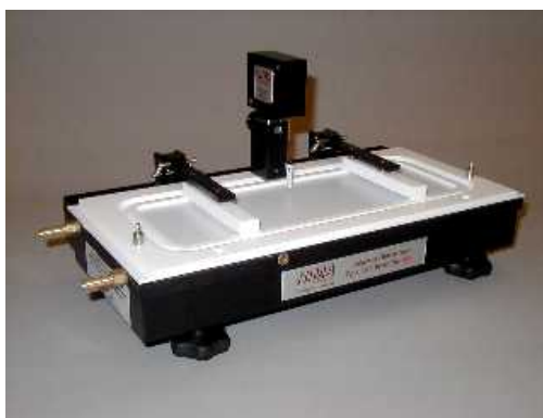
Sl. 18. Langmuirova vaga za mjerenje površinski filmova
