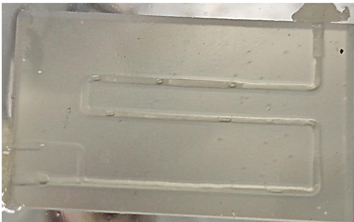
Slika 4.6.4.3. Tok u mikroreaktoru C5K pri \tau = 10,5 min
