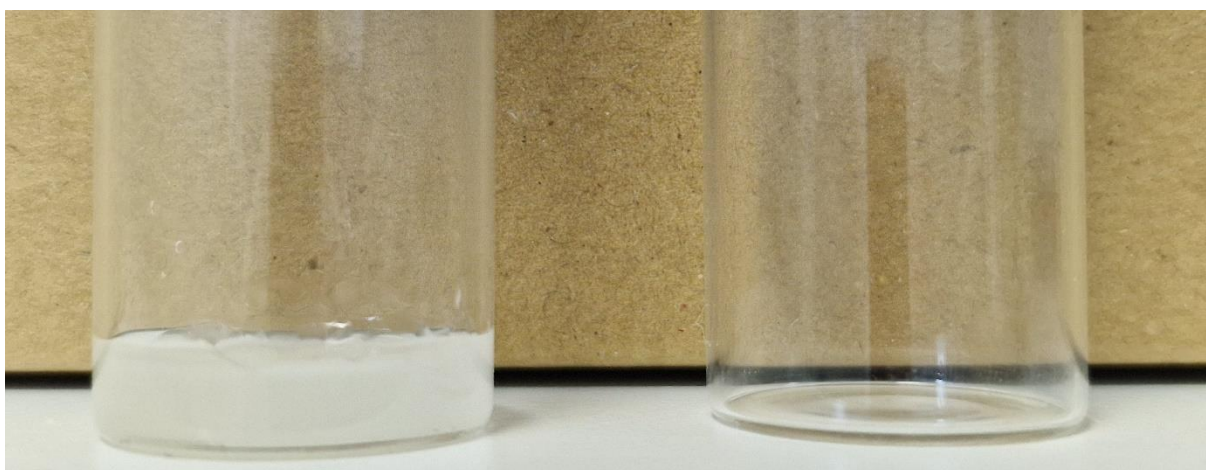
Slika 4.9.3 Rezultati separacije MSv1, MSv2, MSv3, MSv4 i MSv6 – zbog začepljenja cijela smjesa izašla je na jedan izlaz
