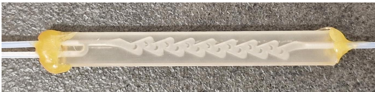
Slika 4.6.2.1. Način spajanja TMod1 mikroreaktora u sustav
