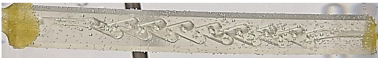
Slika 4.6.2.5. Tok u mikroreaktoru Tmod1 pri \tau = 8 min
