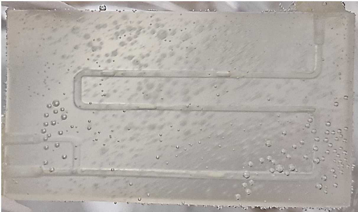
Slika 4.6.4.1. Tok u mikroreaktoru C5K pri \tau = 2,6 min
