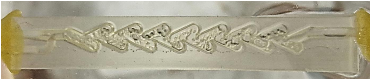
Slika 4.6.3.1. Tok u mikroreaktoru Tmod2 pri \tau = 1 min
