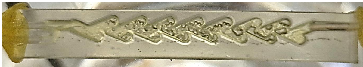
Slika 4.6.3.3. Tok u mikroreaktoru Tmod2 pri \tau = 4 min
