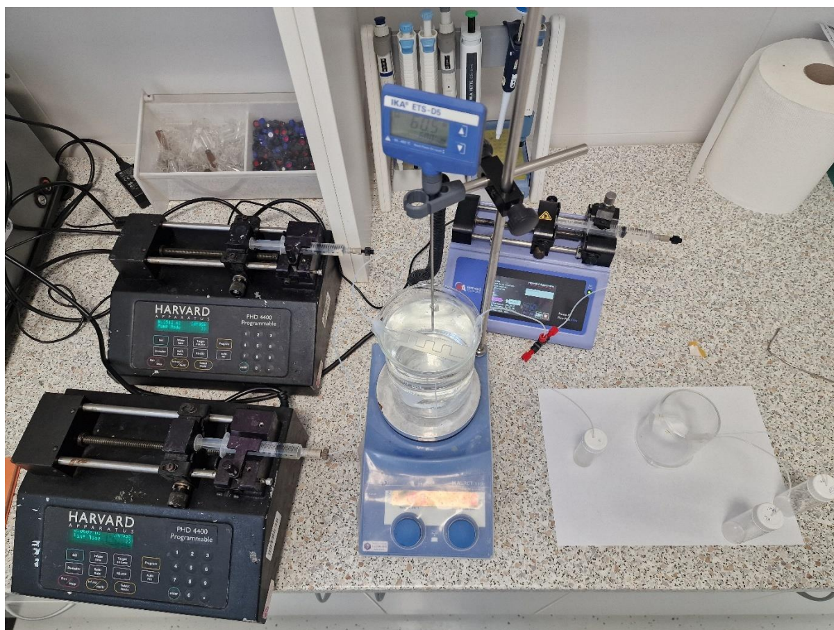
Slika 4.9.1 Integrirani modularni sustav za sintezu i separaciju biodizela
