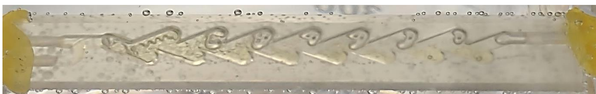
Slika 4.6.3.4. Tok u mikroreaktoru Tmod2 pri \tau = 8 min
