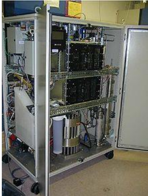
Visokotlačni PEM elektrolizer (PEM – proton exchange membrane)
