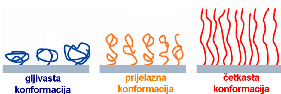
Slika 6.4. Različite konformacije polimernih lanaca cijepljenih na površinu punila
