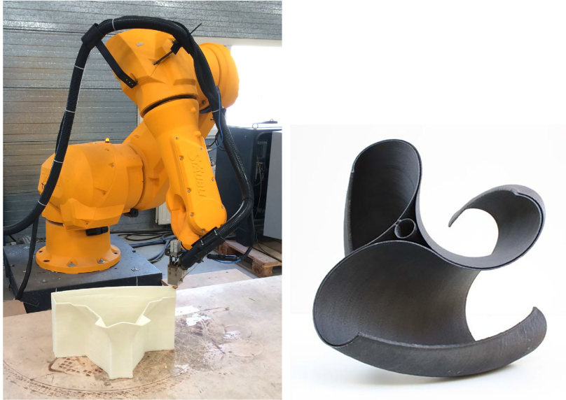
Slika 15.1. Robotski ekstruder na djelu i propeler promjera 0,5 m izrađen njime (PP/staklena vlakna), izvor: Reinforced Plastics 62 (2018) 194-202
