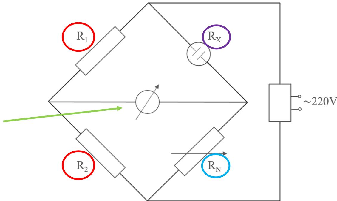
Uz pomoć aparature u laboratoriju cilj je postići minimalni protok struje kroz nul-instrument te uz pomoć navedene jednadžbe  $R_x/R_N = R_1/R_2$  odrediti otpor elektrolita.
