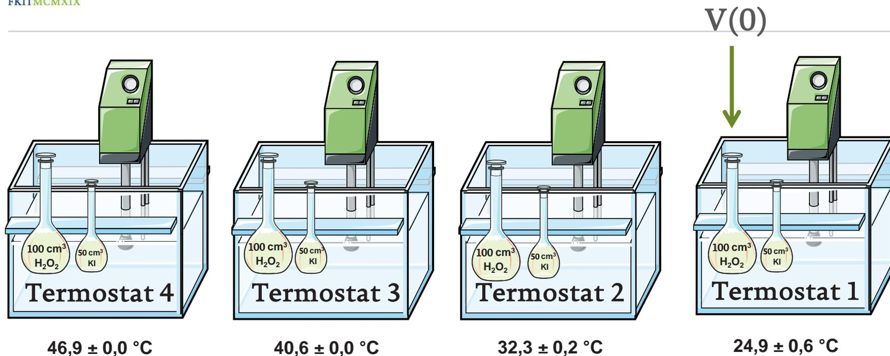
6. Prvo se određuje  $V(0)$ . Uzme se alikvot otopine  $\text{H}_2\text{O}_2$  odmjernom pipetom od  $10 \text{ cm}^3$  i izlije u Erlenmeyerovu tikvicu s  $\sim 25 \text{ cm}^3$  hladne prethodno pripremljene razrijeđene sumporne kiseline za prekid reakcije.
