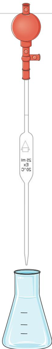
6. Prvo se određuje  $V(0)$ . Uzme se alikvot otopine  $\text{H}_2\text{O}_2$  odmjernom pipetom od  $10 \text{ cm}^3$  i izlije u Erlenmeyerovu tikvicu s  $\sim 25 \text{ cm}^3$  hladne prethodno pripremljene razrijeđene sumporne kiseline za prekid reakcije.
