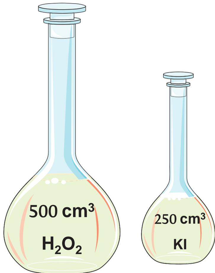
1. Pripreme se otopine  $\text{H}_2\text{O}_2$  i KI zadanih koncentracija u odmjernim tikvicama od 500 i 250 cm<sup>3</sup> zadanih koncentracija.
