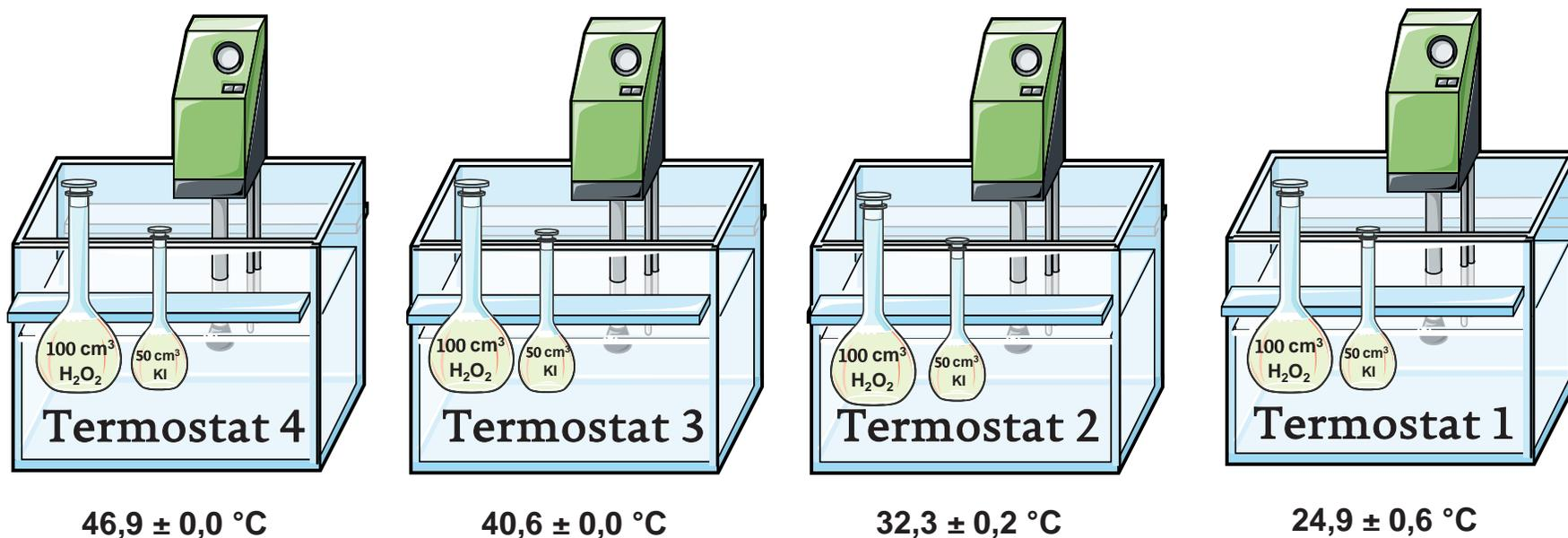
2. Otopine se odmah rastoče u četiri para odmjernih tikvica od 100 i 50 cm<sup>3</sup>, i po jedan par se stavi u svaki termostat.
