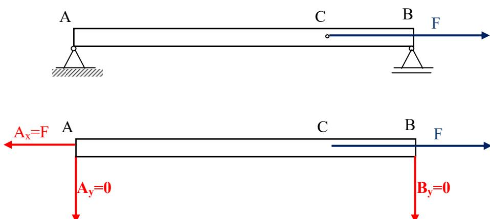
Sila F kao aktivna sila i crveno obojane reaktivne sile od koji je samo  $A_x$  različita od nule su vanjske sile. Te vanjske sile izazivaju opterećenja na unutarnjem presjeku/presjecima štapa.
