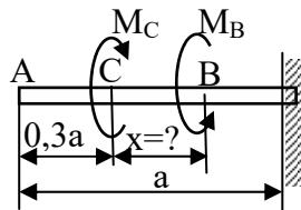
U tekstu je definiran pozitivni smjer djelovanja momenta što je bitno zbog zadanog predznaka zakreta točke A. to znači da će točka biti zakrenuta u smjeru djelovanja momenta  $M_C$ . Riješimo sada zadatak i napišimo izraz za zakret točke A.
