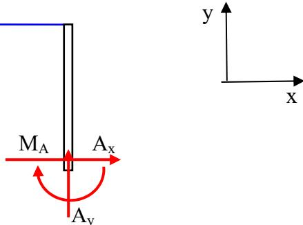
Oslonac u točki A naziva se **uklještenje** i prenosi dvije komponente **reaktivne sile  $A_x$  i  $A_y$**  i **reaktivni moment  $M_A$** !
