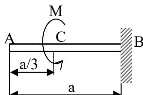
Rješenje:  $\tau=99,4 \text{ MPa (između točaka B i C)}$ ,  $\varphi_A=\varphi_C=0,03316 \text{ rad (}1,9^\circ\text{)}$ .
