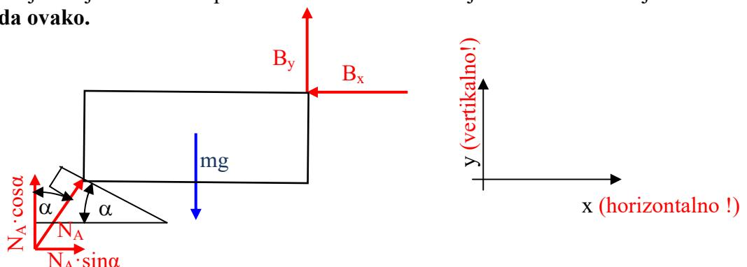
U točki B se nalazi **nepomični oslonac** koji prenosi **dvije komponente sile reakcije** (vidjeti predavanja). Te dvije komponente su uvijek međusobno okomite! U tekstu zadatka se traži određivanje iznosa horizontalne komponente  $B_x$  što znači da je njoj pripadajuća vertikalna komponenta  $B_y$ .
