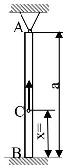
Rješenje:  $x=572,5 \text{ mm}$ ,  $\sigma_{A-C}= - 93,3 \text{ MPa}$ ,  $\sigma_{C-B}=0 \text{ MPa}$ .
