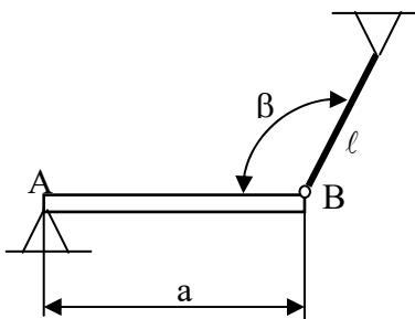
Rješenje:  $\sigma=17,96 \text{ MPa}$ ,  $\Delta\ell=0,038 \text{ mm}$ ,  $|\Delta\ell_\ell|=0,124 \text{ mm}$  (skraćenje uslijed hlađenja).
