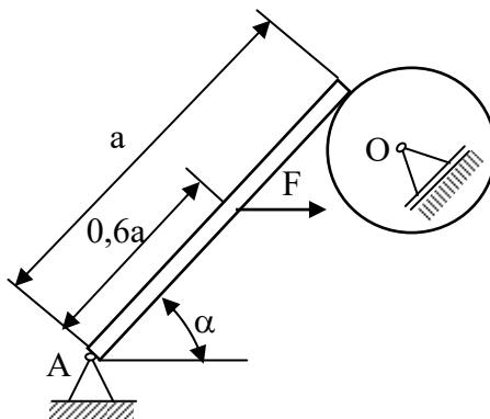
**Rješenje:**  $A_x=87,8 \text{ N}$ ,  $A_y=35,8 \text{ N}$ ,  $O_x=32,2 \text{ N}$ ,  $O_y=35,8 \text{ N}$ .
