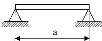
Komentar: iz zadanih podataka vidljivo je da je štap bio prekratak pa ga je prilikom ugradnje trebalo produljiti (aksijalnom silom) zbog čega se u štalu pojavilo početno vlačno naprezanje.
