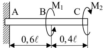
Zakret točke C računa se prema izrazu:
