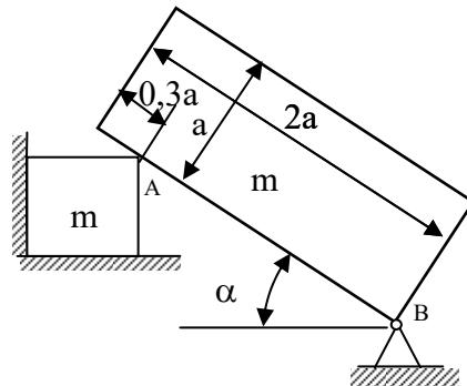
Rješenje:  $B_x=6,58 \text{ N}$ ;  $B_y=24,9 \text{ N}$ ;  $N_A=13,15 \text{ N}$ ; reakcije između horizontalnog bloka i podlove;  $N_1=47,7 \text{ N}$ ;  $N_2=6,58 \text{ N}$ .
