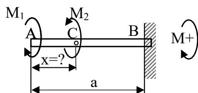
Rješenje:  $x=218,1 \text{ mm}$ ,  $\varphi_C=0,00524 \text{ rad } (0,3^\circ)$ .
