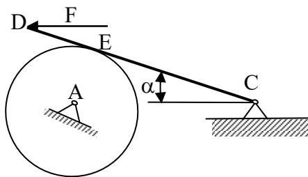
Rješenje:  $A_x=31,5 \text{ N}$ ;  $A_y=67,5 \text{ N}$ ;  $C_x=88,5 \text{ N}$ ;  $C_y=47,9 \text{ N}$ .
