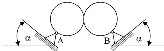
**Rješenje:** sila u točki dodira  $N=34,3 \text{ N}$ ;  $A_x=B_x=34,3 \text{ N}$ ;  $A_y=B_y=49,1 \text{ N}$ .
