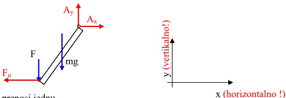
Uže prenosi jednu komponentu sile na način da uže uvijek ostane napetopaziti na orientaciju vektora!
