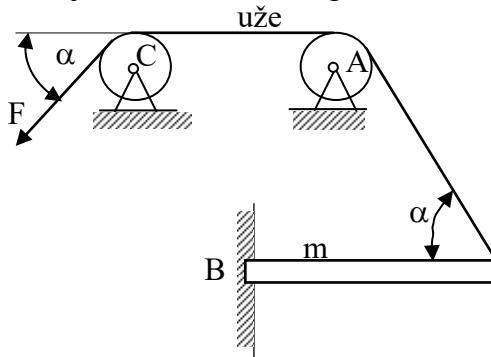
**Rješenje:**  $A_x=3,37 \text{ N}$ ;  $A_y=10,7 \text{ N}$ ;  $B_x=15,28 \text{ N}$ ;  $B_y=136,45 \text{ N}$ ;  $M_B=44,01 \text{ Nm}$ .
